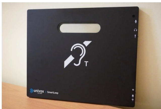
Rysunek 35 Pętla indukcyjna znajdująca się punkcie informacyjnym Urzędu Miasta i Gminy w Chorzelach, źródło: Urząd Miasta i Gminy w Chorzelach
